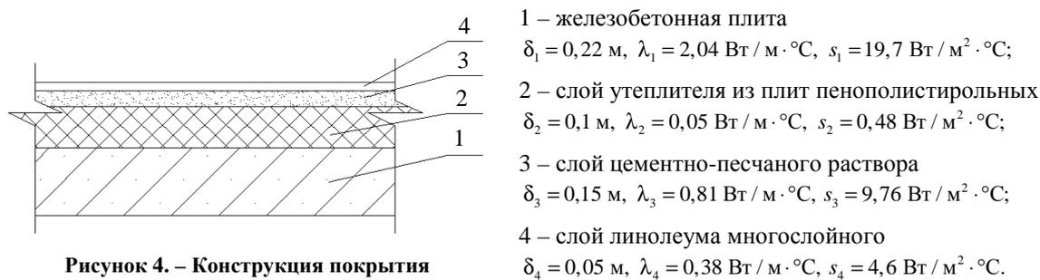
Рисунок 4. – Конструкция покрытия над неотапливаемым подвалом
