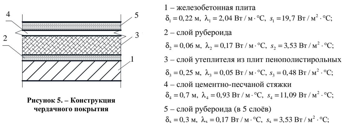
Рисунок 5. – Конструкция чердачного покрытия
