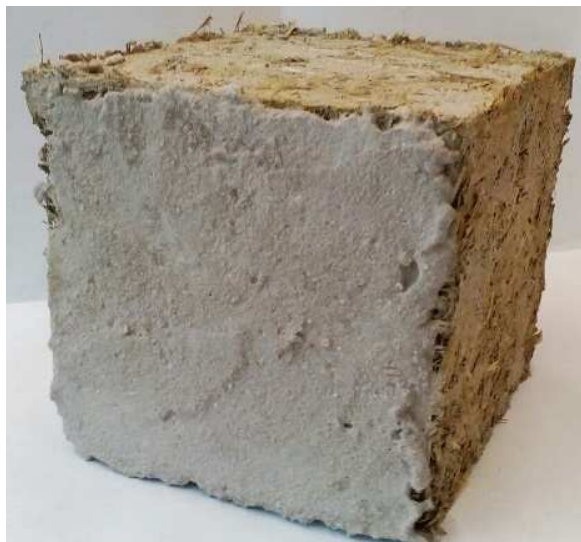
Рисунок 2. – Поверхность арболита, оштукатуренная цементно-известковым раствором марки 50
