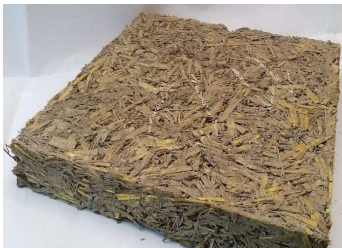
Рисунок 1. – Плита на основе смеси соломы и костры льна
