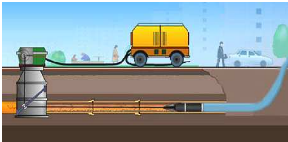
Рисунок 2. – Метод «труба в трубе»
