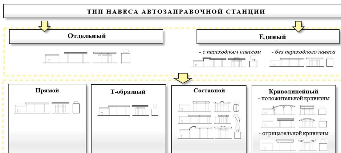
Рисунок 3. – Классификация навесов над ТРК
