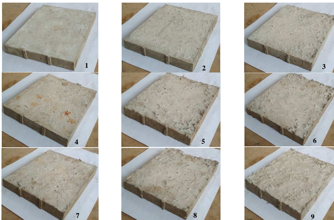
Рисунок 1. – Цементно-песчаные плиты, дисперсно-армированные отходами производства стеклосетки
