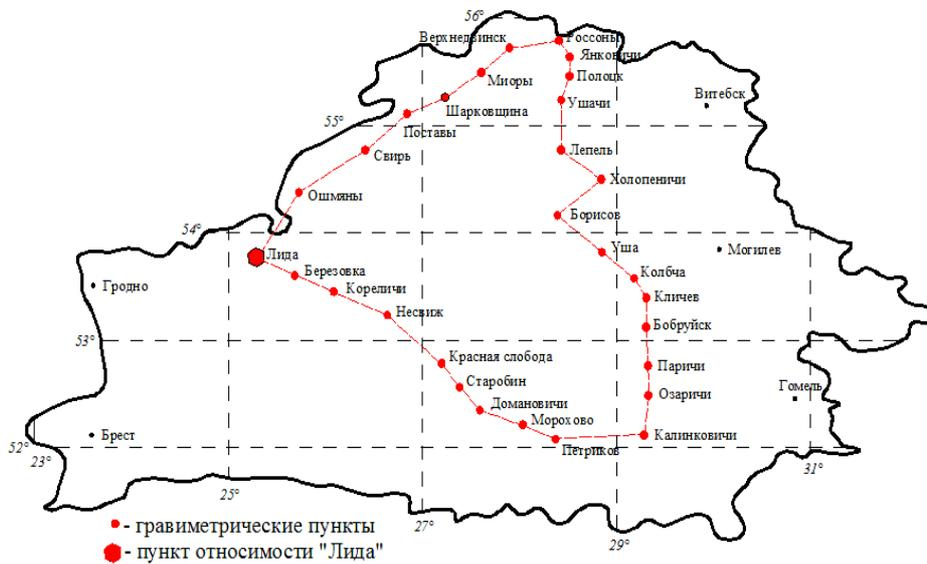
Рисунок 2. – Схема геодинимического гравиметрического полигона Беларуси
