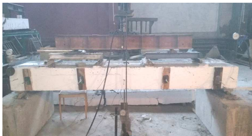
Рисунок 2. – Общий вид стенда для испытания плит
