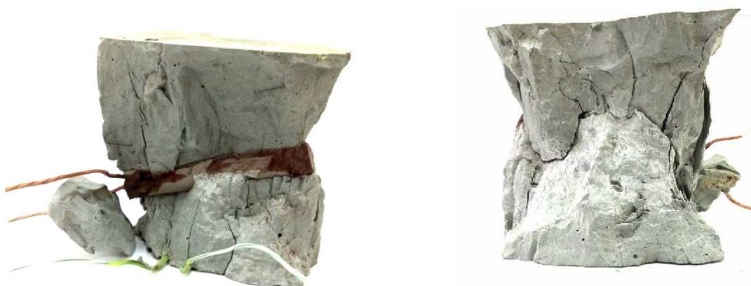
**Рисунок 4. – Характер разрушения цементного куба с установленным в него глубинным датчиком**
