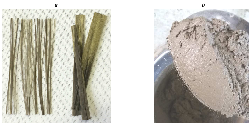
Рисунок 1. – Базальтовое фиброволокно в естественном состоянии (а) в цементно-песчаной смеси (б)
