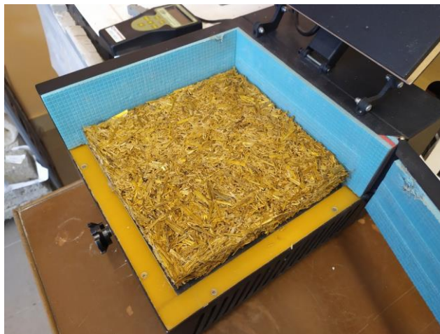
Рисунок 5. – Внешний вид плиты на основе смеси рисовой лузги и резанной соломы (состав 4) в приборе ИТП-МГ4
