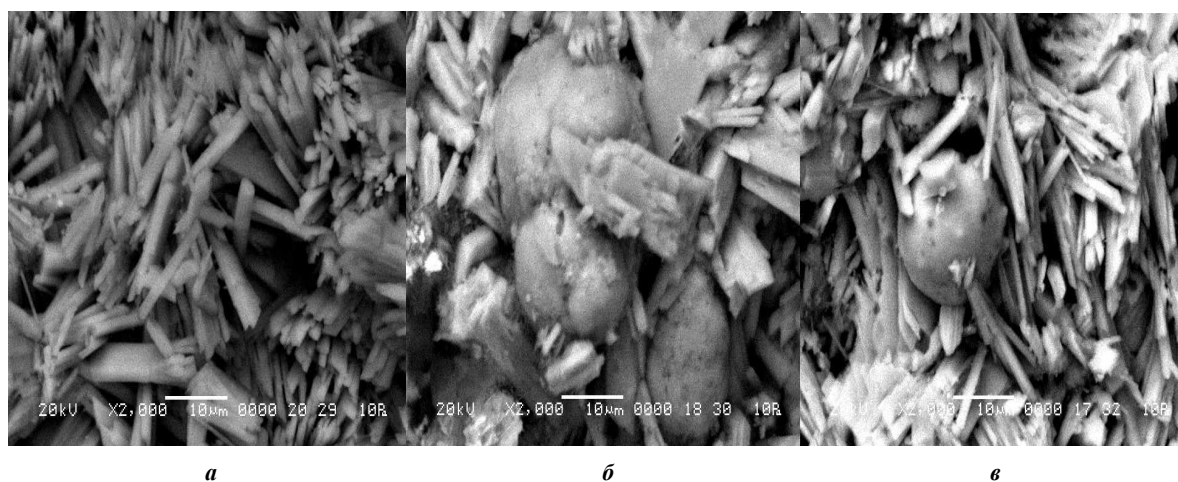
Рисунок 1. – Микроструктура гипсового камня в возрасте 28 суток при увеличении 2000 крат: гипсовый камень без добавок (а); гипсовый камень с добавкой байпасной пыли 5% и дефеката 15% (б); гипсовый камень с добавкой байпасной пыли (5%) и шлама водоподготовки 15% (в)
