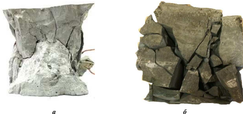
Рисунок 1. – Разрушенные образцы цементного камня: при нормально-влажностных условиях (а); с хлоридной коррозией (б) – находился в соляном растворе 45 суток
