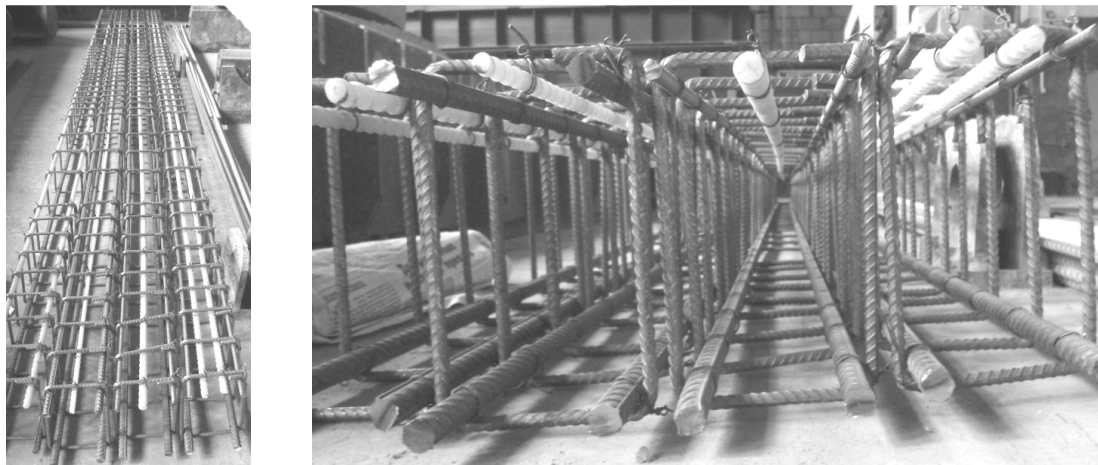
Рисунок 2. – Общий вид вязаных каркасов образцов-балок
