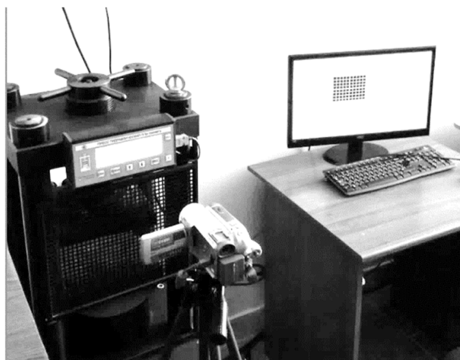
Рисунок 6. – Установка камеры для считывания информации с дисплея гидравлического пресса
