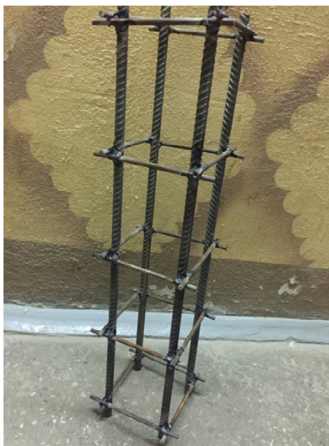
Рисунок 3. – Арматурный каркас для измерения стесненной усадки
