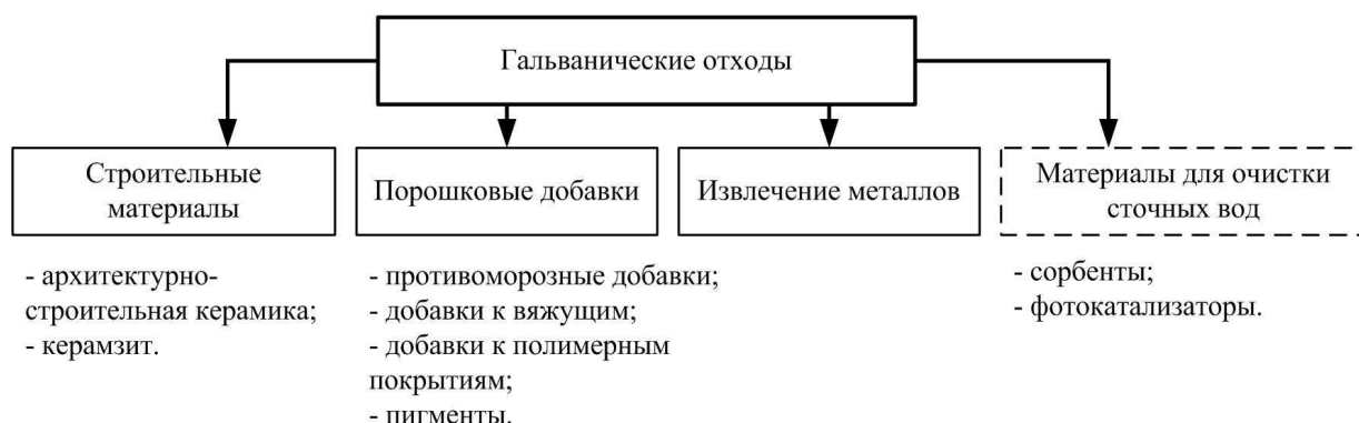
Рисунок 2. – Направления использования отходов гальванических производств
