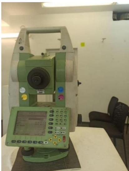
Рисунок 5. – Leica TCR 1201 1" на тумбе с принудительным центрированием
