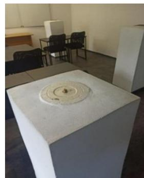
Рисунок 4. – Тумба для установки прибора
