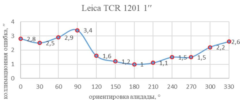
Рисунок 10. – Колебания коллимационной ошибки тахеометром Leica TCR 1201 1''
