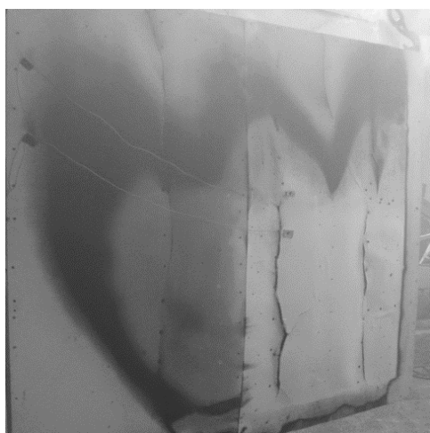
Рис. 4. Образец при испытании 45 минут без защитного слоя гипсокартона
