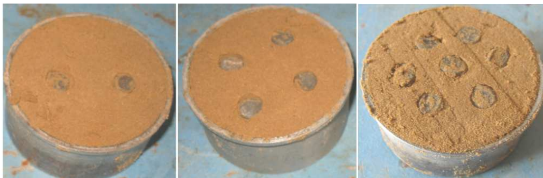
Рисунок 1 – Общий вид образцов из мелкого песка для сдвиговых испытаний с разным процентом армирования от 10 до 30%
