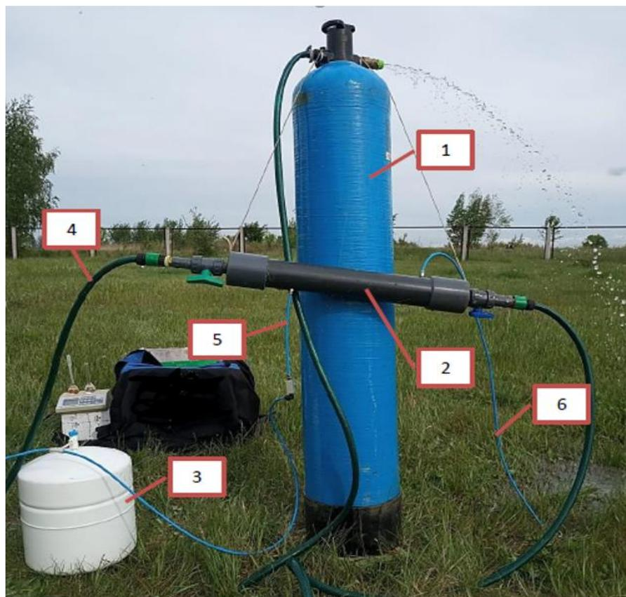
1 – основная колонна с загрузкой, диаметром 250 мм; 2 – аэрационный смеситель или колонна; 3 – ресивер компрессора; 4 – подача исходной воды; 5 – подача воздуха; 6 – выпуск воздуха
