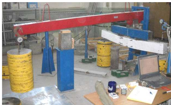
Рис. 2. Общий вид рычажной установки для испытания балок
