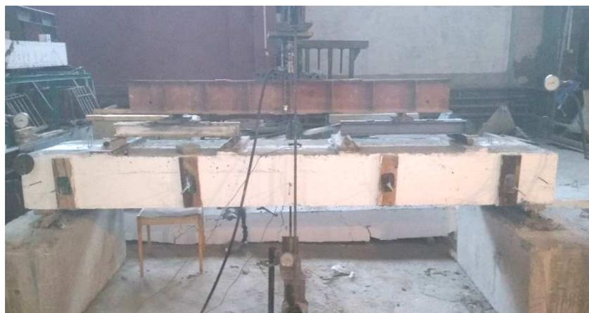
Рисунок 2. – Общий вид стенда для испытания плит
