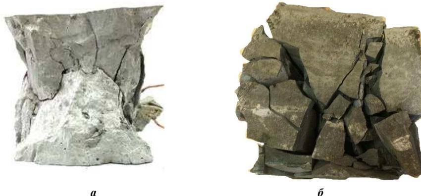
**Рисунок 1. – Разрушенные образцы цементного камня:
