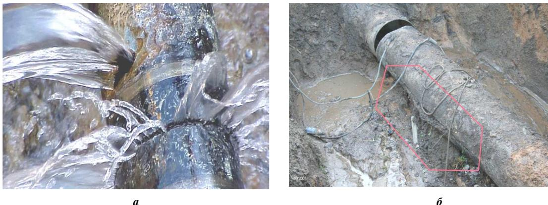
*a* – свищи (дыры), трещины; *б* – переломы, разрывы
