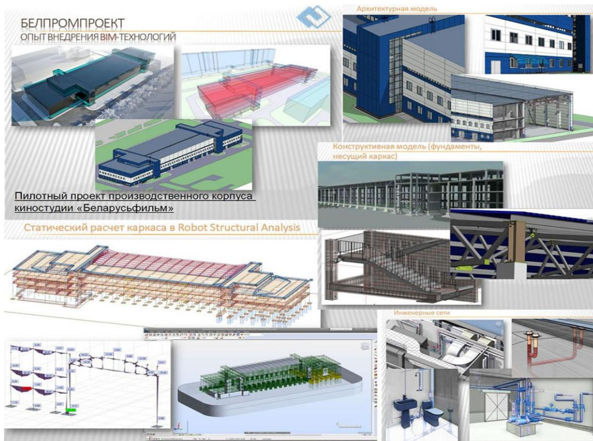
Рисунок 1. – Пилотный проект производственного корпуса киностудии «Беларусьфильм», выполненный в BIM (УП «Белпромпроект»)
