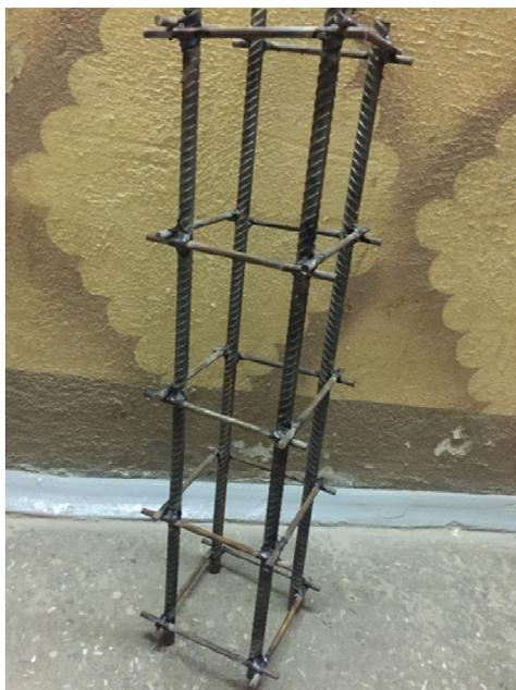
**Рисунок 3. – Арматурный каркас для измерения стесненной усадки**
