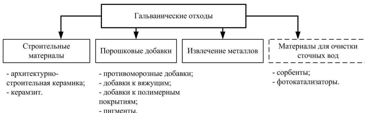
**Рисунок 2. – Направления использования отходов гальванических производств**
