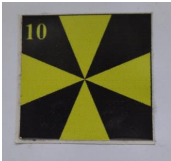
Рисунок 6. – Визирная марка, используемая для наведения
