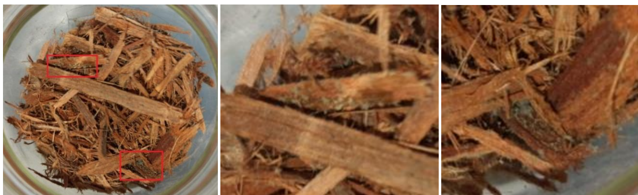
Рисунок 12. – Плесневелые грибы на некарбонизированных волокнах крупной фракции (2,5–5 мм)
