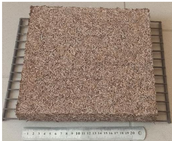
Рисунок 10. – Плита на основе волокон коры эвкалипта (средняя фракция) и жидкого стекла (состав 2)
