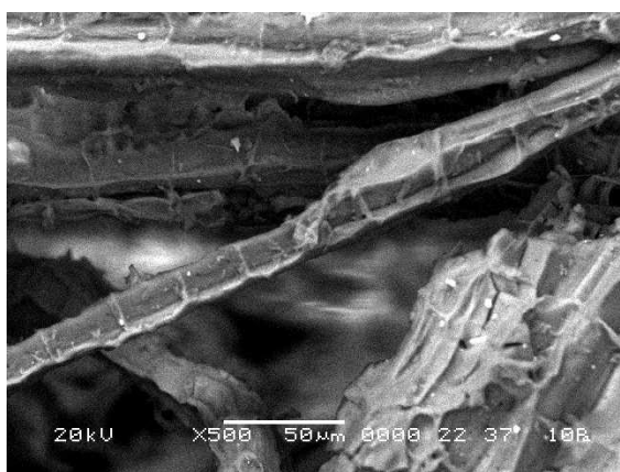
Рисунок 3. – Волокна после измельчения коры эвкалипта (500-кратное увеличение)
