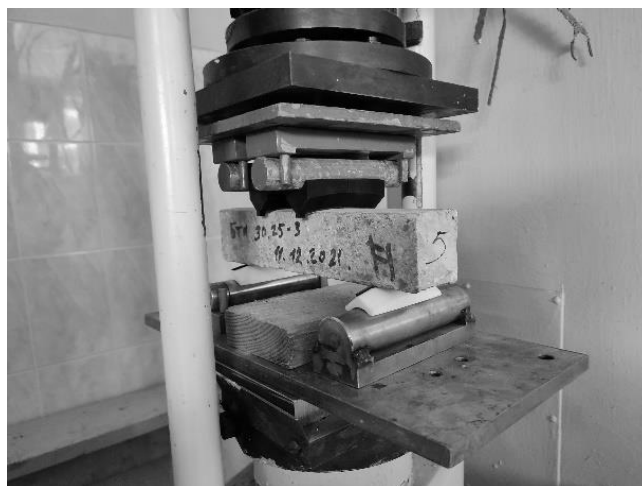
Рисунок 6. – Испытания образцов-балок, отобранных из трубы диаметром 300 мм, отформованной методом радиального прессования
