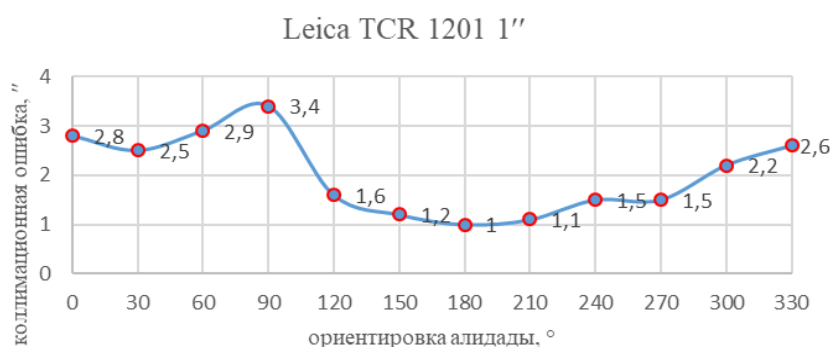
Рисунок 10. – Колебания коллимационной ошибки тахеометром Leica TCR 1201 1''
