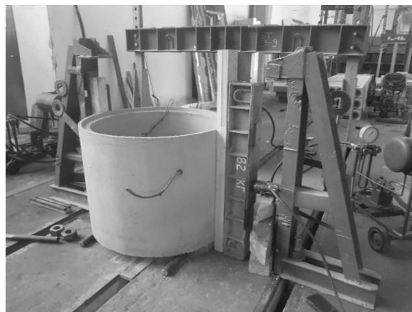
Рисунок 4. – Внешний вид испытательного стенда и образца кольцевого сечения диаметром 1000 мм, заформованного методом вибропрессования
