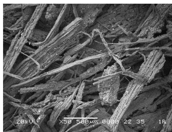
Рисунок 4. – Волокна после измельчения коры эвкалипта (50-кратное увеличение)
