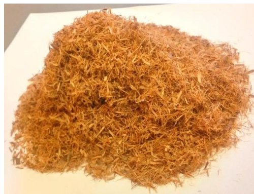
Рисунок 5. – Волокна коры эвкалипта разных фракций (начало)
