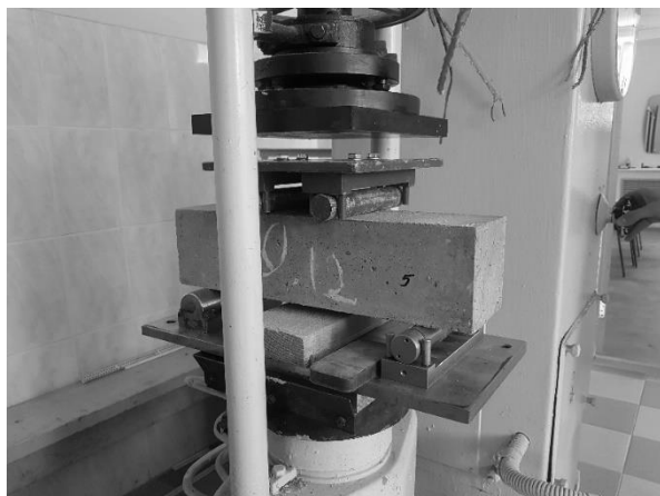
Рисунок 3. – Испытание образца-призмы 100×100×400 мм
