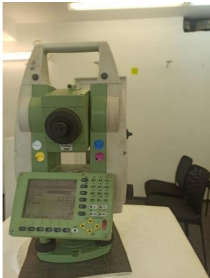
Рисунок 5. – Leica TCR 1201 1" на тумбе с принудительным центрированием
