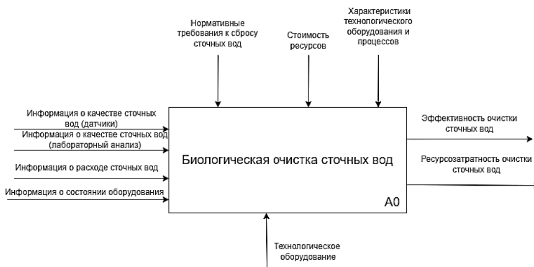
Рисунок 1. – Контекстная диаграмма контроля эффективности блока биологических очистных сооружений
