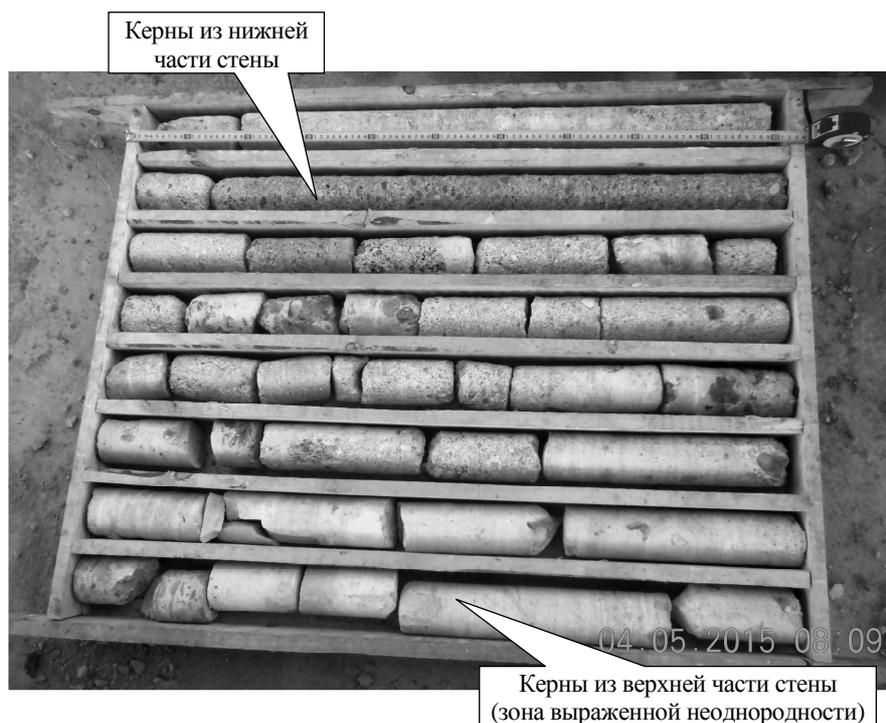
Рисунок 5 – Керны, отобранные из тела стенки
