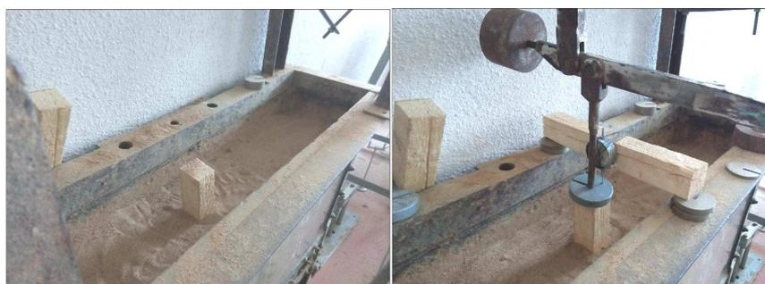
*а)* – свая, защемленная в несвязном грунте; *б)* – нагружение сваи
