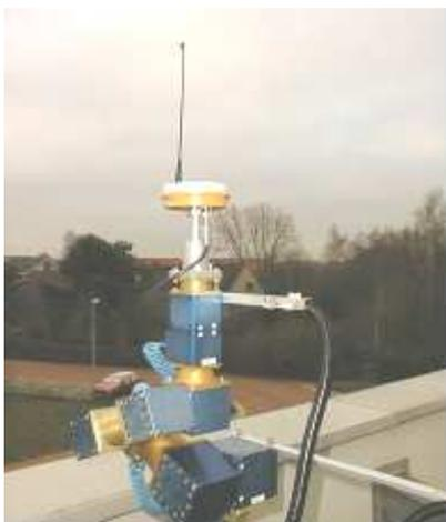
Рисунок 2 – Робот DSNDGU\_002\_UHF\*, выполняющий абсолютные калибровки антенн
