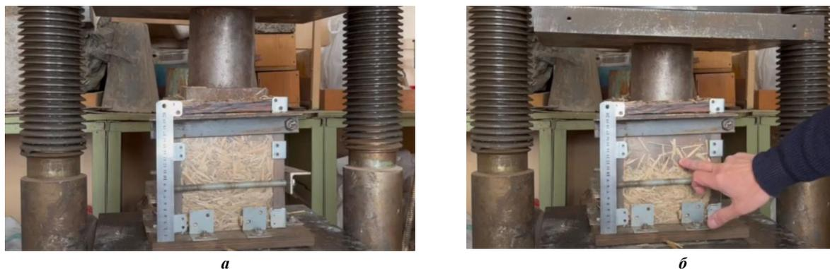
*a* – форма с соломой до испытаний; *б* – форма с соломой при фиксировании крышки на расстоянии 150 мм от нижней грани
