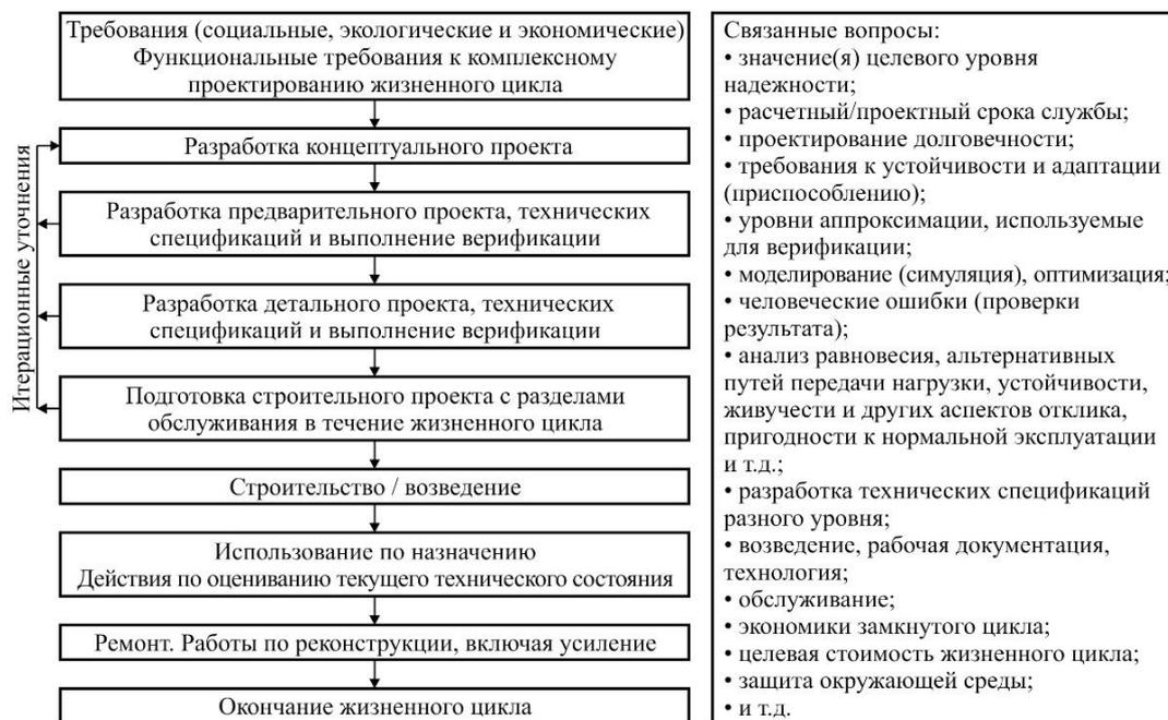
Рисунок 1. – Схема проектирования здания на основе методологии «performance-based design» с учетом обеспечения требований полного жизненного цикла согласно *fib Model Code 2020*<sup>2</sup>
