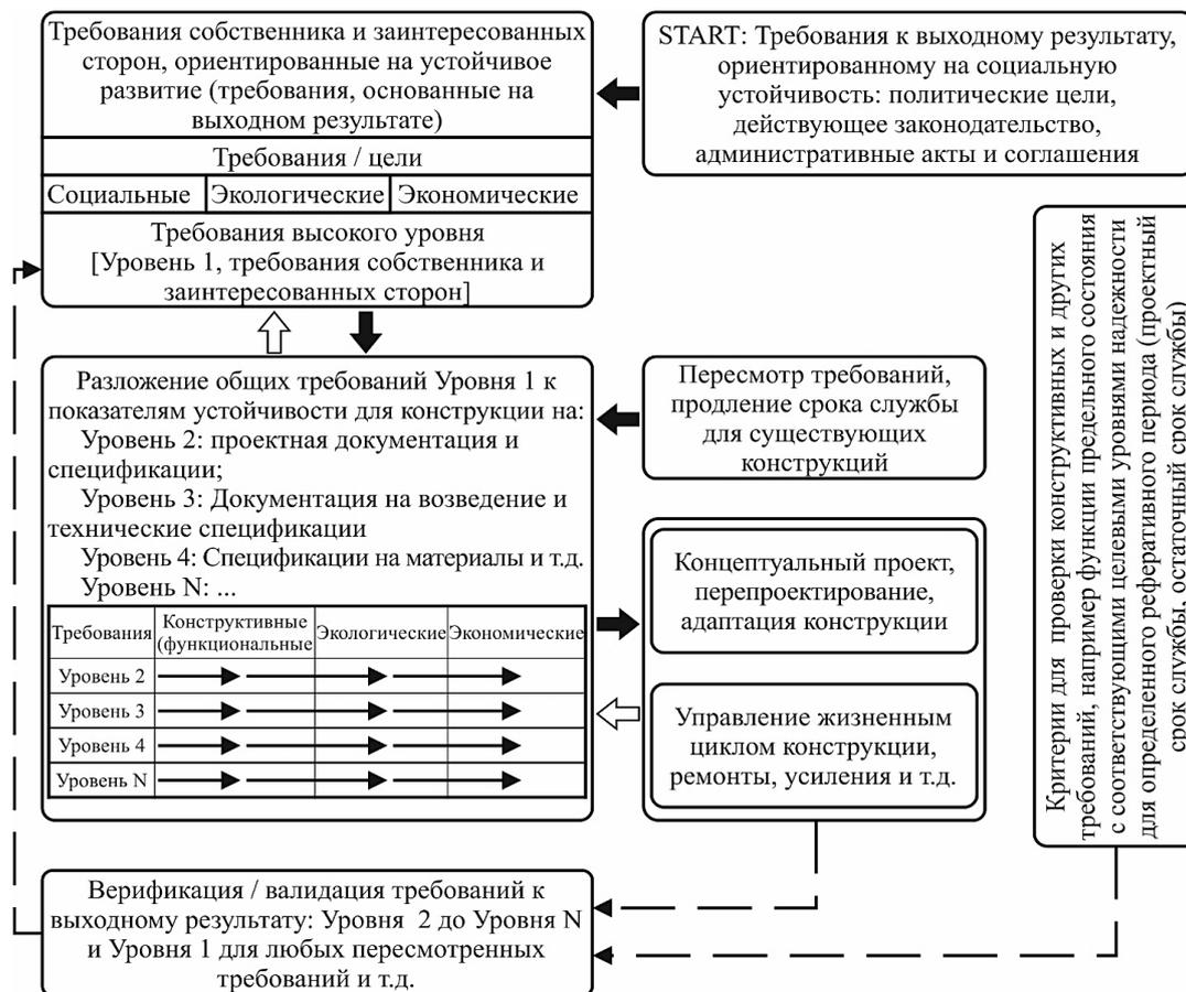
Рисунок 2. – Упрощенная схема многоуровневого подхода к проектированию на основе выходного результата для полного жизненного цикла здания с акцентом на блоки «Требования»-«Верификация» согласно *fib Model Code 2020*<sup>3</sup>
