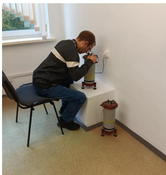
Рисунок 4. – Исследование гравиметров ГНУКВ на смещение нуля-пункта
