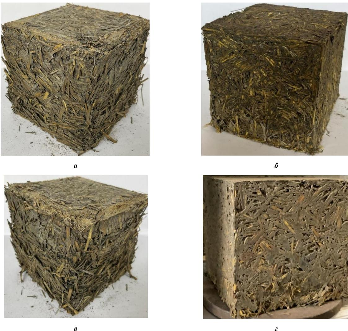
*a* – разуплотненная структура (состав 1.15); *б* – сформированная, связная структура (состав 1.17); *в* – разуплотненная структура (состав 1.21); *г* – сформированная, связная структура (состав 1.23)
