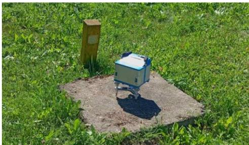
Рисунок 5. – Выполнение гравиметрических измерений гравиметром Scintrex CG-6 AutoGrav на одном из пунктов Полоцкого геодинамического профиля
