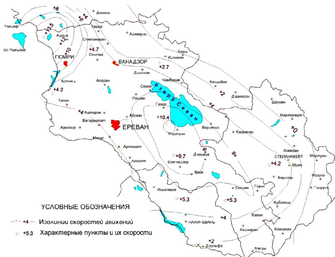
Рис. 2. Карта современных движений земной коры по результатам геодезических измерений
