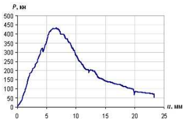
Рис. 5. Диаграмма деформирования каменной кладки по образцам серии 1, а также экспериментальная зависимость «нагрузка – деформации» образца СЗ [17]
