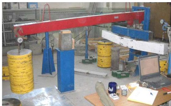
Рис. 2. Общий вид рычажной установки для испытания балок
