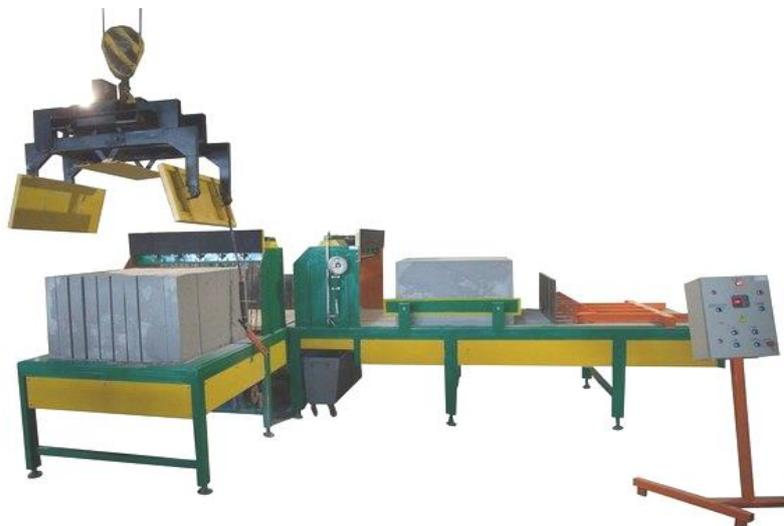
Рис. 2. Установка для резки пенобетонных массивов
