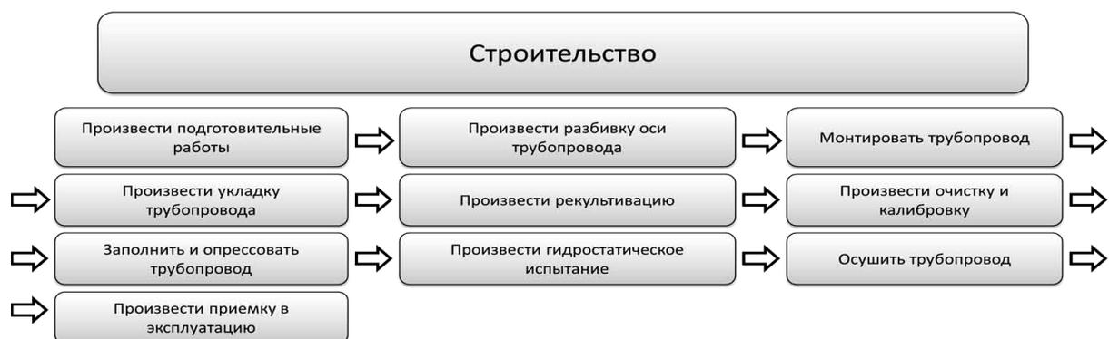
Рис. 2. Стадия жизненного цикла «строительство» на примере магистрального трубопровода
