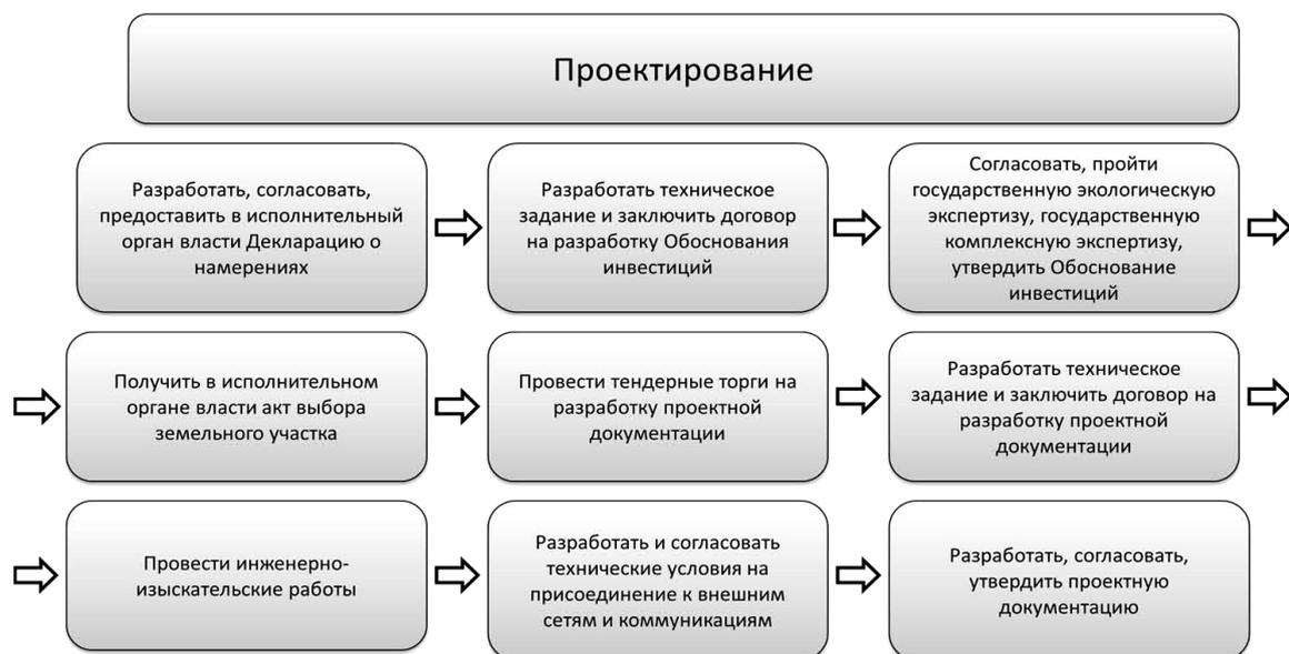
Рис. 1. Стадия жизненного цикла «проектирование» в магистральном трубопроводном транспорте
