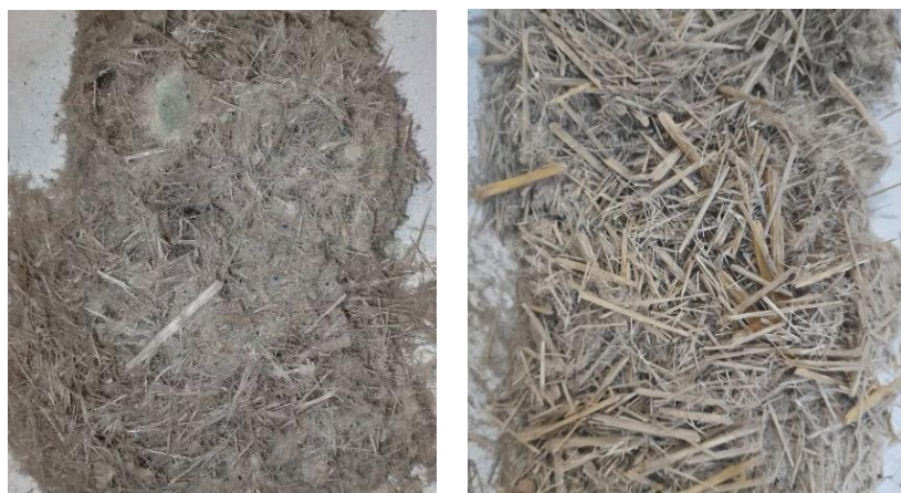
а – стеклохолст, связующее на основе полиэфирной смолы Депол С-180 ПТ; б – стеклоармированные стержни, связующее на основе эпоксидной смолы ЭД-20
