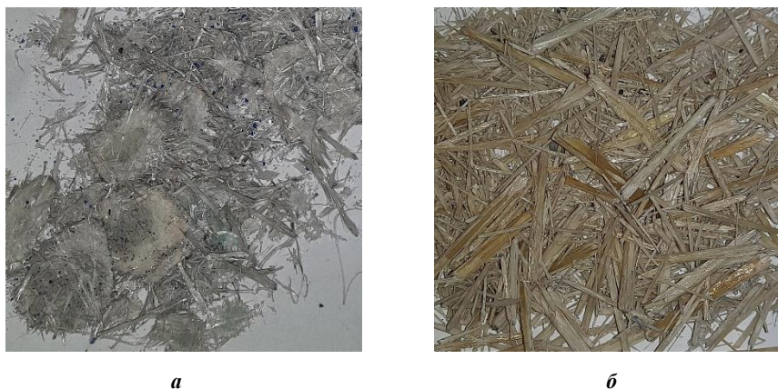
а – стеклохолст, связующее на основе полиэфирной смолы Депоп С-180 ПТ; б – стеклоармированные стержни, связующее на основе эпоксидной смолы ЭД-20
