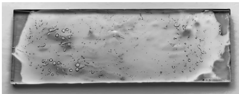
Рисунок 1. – Внешний вид пленки композиционного биовязущего на стеклянной подложке
