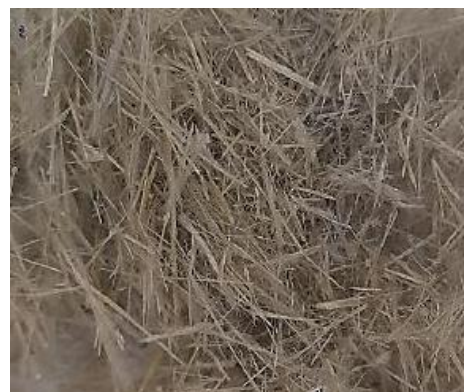
a – зависимость остатка волокнистой фракции стеклопластиков Депоп С-180 ПТ и ЭД-20 от диаметра отверстий сита; б – волокнистая фракция, полученная из отходов стеклопластика ЭД-20
