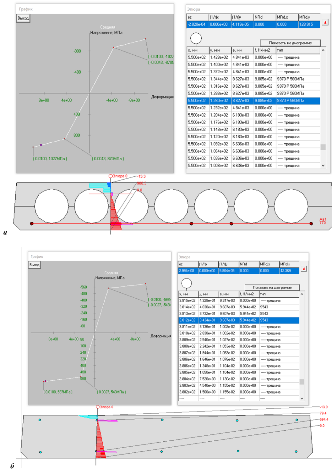
Рисунок 6. – Результаты вычисления параметров напряженно-деформированного состояния плит перекрытий в предельной стадии (цифры на выносных линиях – нормальные напряжения в МПа; синим и красным цветом показано распределение по высоте поперечного сечения относительных деформаций соответственно в сжатой и растянутой зонах; голубым и розовым – аналогично, нормальных напряжений; графики – диаграмма деформирования арматуры)
