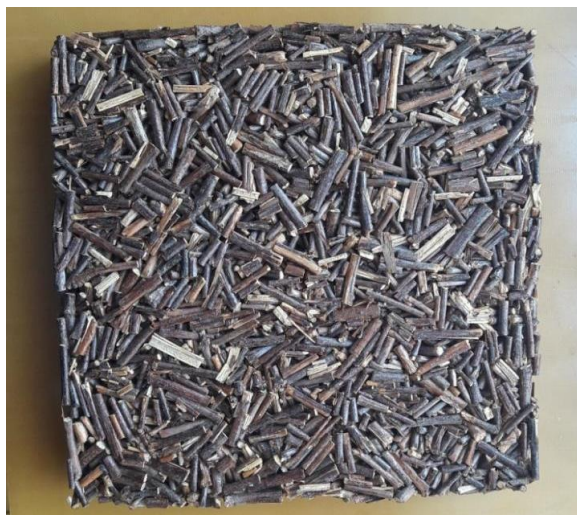
Рисунок 5. – Образец-плита на основе жидкого стекла и дробленного хлопчатника
