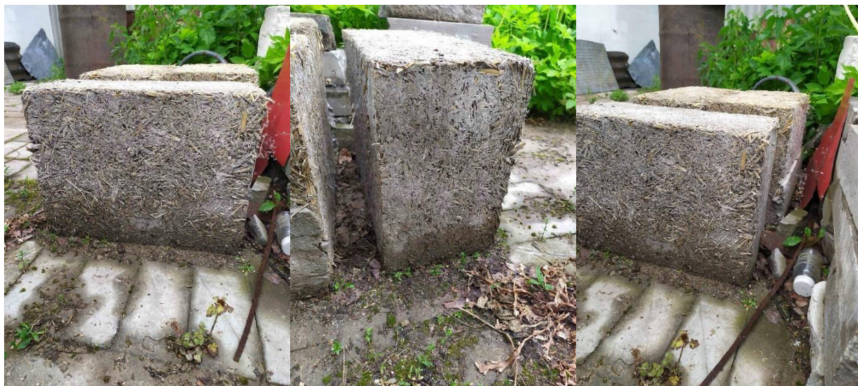
Рисунок 6. – Блоки под прямым атмосферным воздействием (составы 1, 2)
