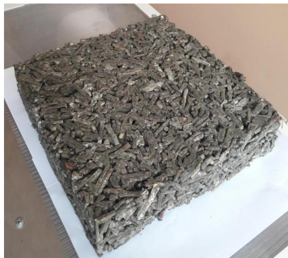
Рисунок 6. – Образец-плита на основе цемента и дробленного хлопчатника
