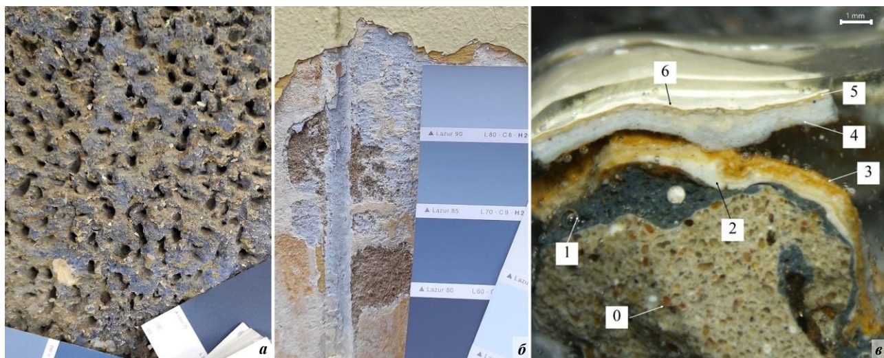
а – раскряцце гістарычных фарбавальных пластоў на бучардзе руста; б – раскряцце гістарычных фарбавальных пластоў плоскасці сцяны будынка; в – стратыграфічны аналіз фарбавальных пластоў цэнтральнай часткі руста (мікрафотаздымак): 0 – тынкі; 1 – першы фарбавальны шэра-сіні слой; 2 – падрыхтоўчы слой; 3 – фарбавальны слой цёмна-охрысты; 4 – падрыхтоўчы слой; 5 – фарбавальны слой светла-жоўты; 6 – фарбавальны слой малочна-белы
