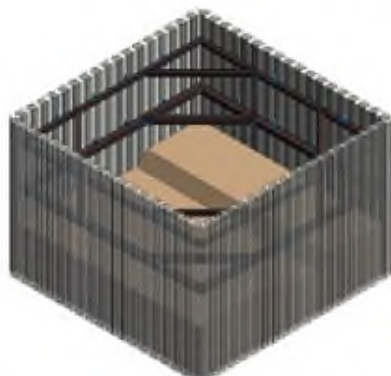
Цифровая модель ограждающих конструкций котлована
