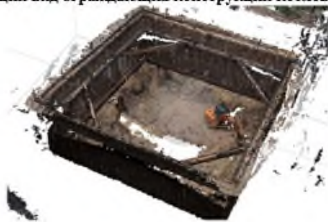
Облако точек ограждающих конструкций котлована
