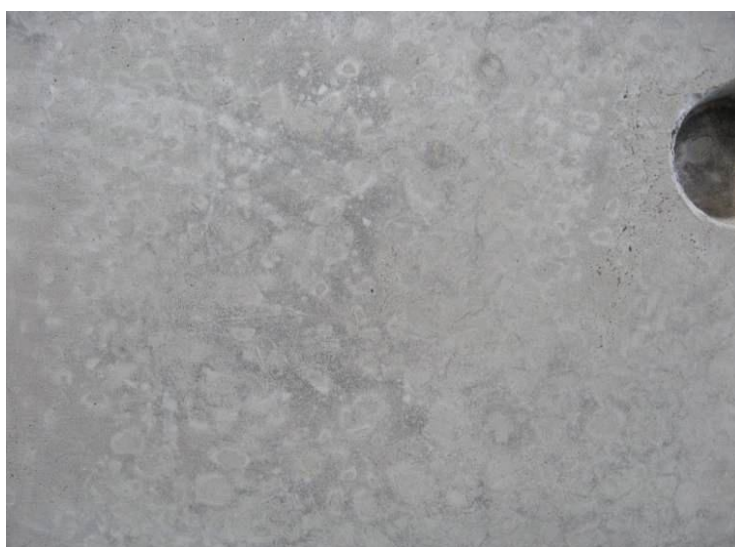
Рис. 6. Образец поверхности бетонной плиты после применения в качестве смазки для разборной стальной опалубки эмульсии на основе экстракта нефтяного, жирной кислоты растительных масел и неонола (концентрат эмульсола)
