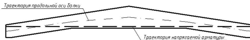
Рисунок 1. – Балка ломаного очертания с прямолинейной напрягаемой арматурой
