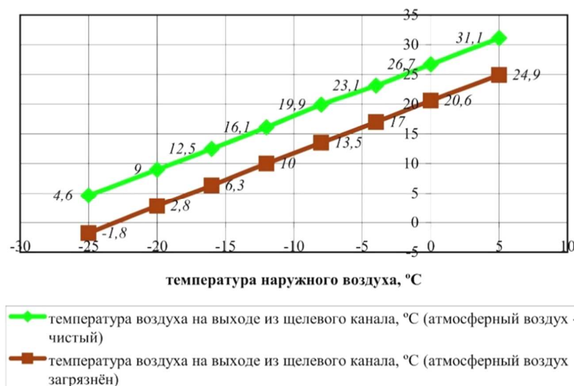
Рисунок 5. – Изменение температуры приточного воздуха в воздухоприемном канале при различных условиях загрязнения атмосферы
