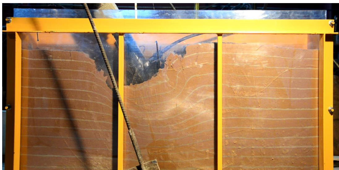
Рисунок 2. – Потеря устойчивости однородного песчаного основания
