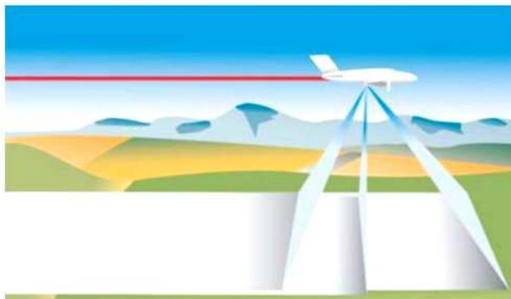
Рисунок 1. – Принцип работы линейного ПЗС-приемника
