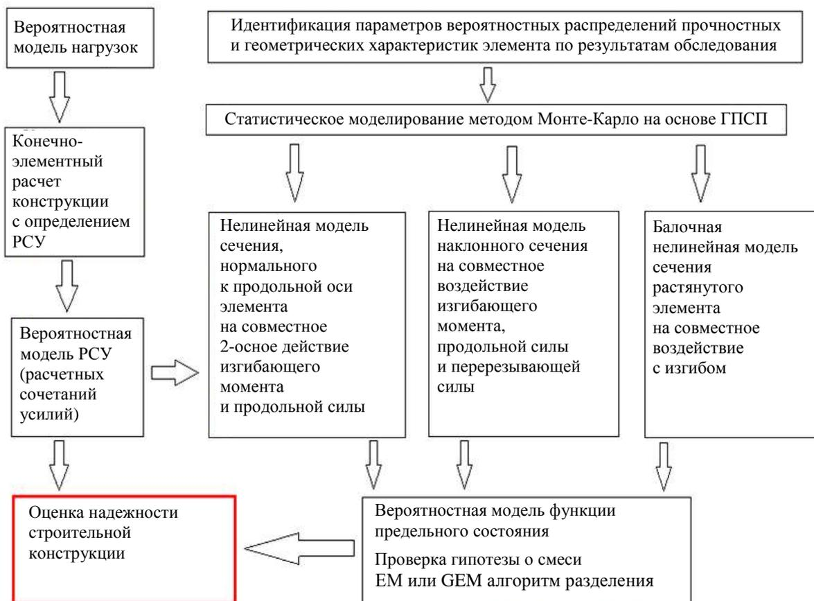
Рисунок 2. – Общая схема полного вероятностного нелинейного расчета
