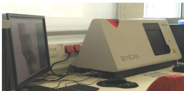
Рисунок 1. – Внешний вид томографа «SkyScan1174v2»
