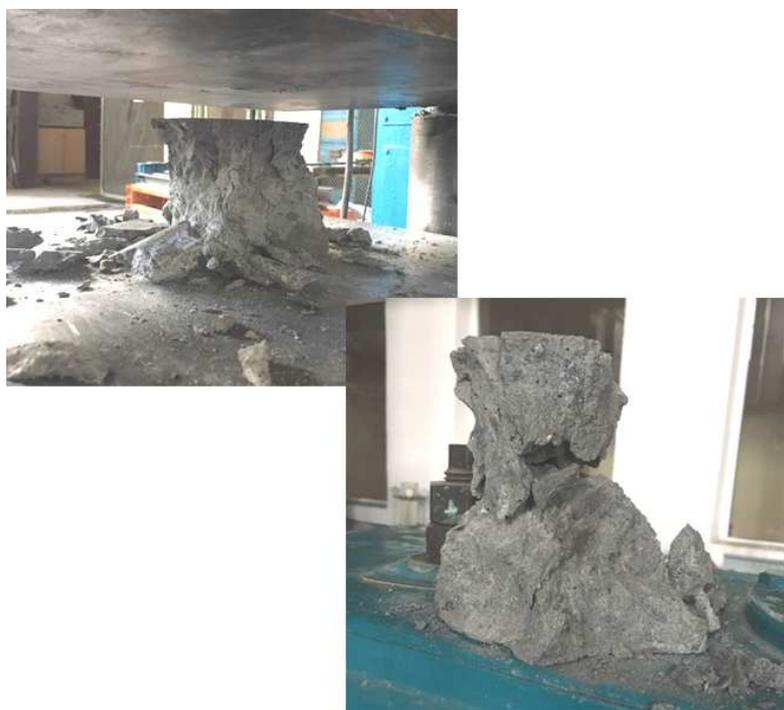
**Рисунок 2. – Вид разрушения опытных образцов**
