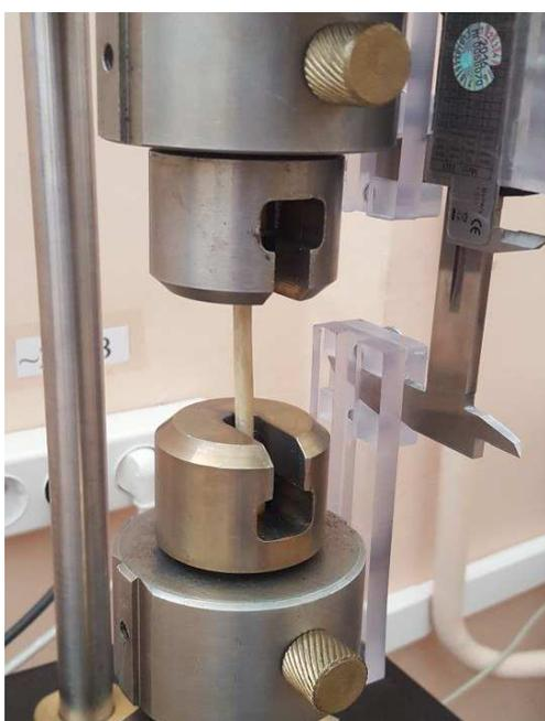
Рисунок 1. – Образец в разрывной машине
