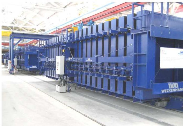
**Рисунок 1. – Кассетные формы
