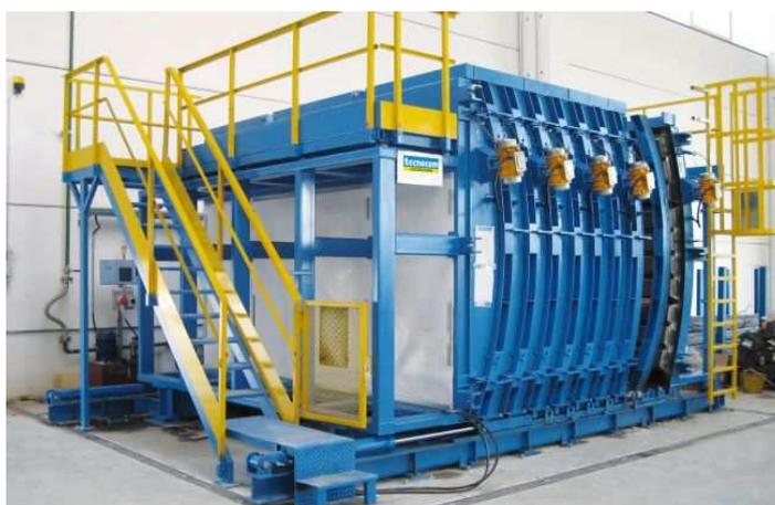
Рисунок 2. – Кассетные формы
