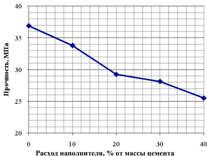
Рисунок 2. – Изменение прочности в зависимости от расхода наполнителя (7 суток)
