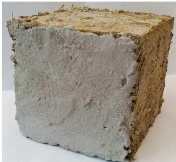
Рисунок 2. – Поверхность арболита, оштукатуренная цементно-известковым раствором марки 50
