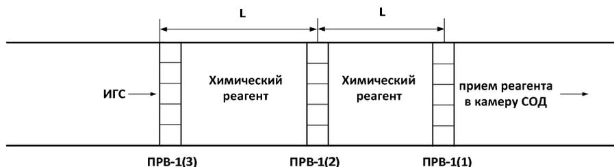
Рисунок 7. – Пробка растворителя последнего этапа очистки
