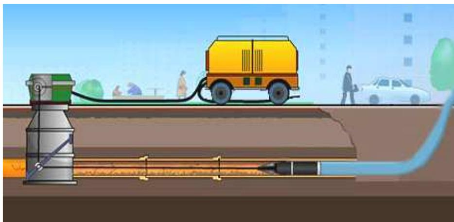
**Рисунок 2. – Метод «труба в трубе»**
