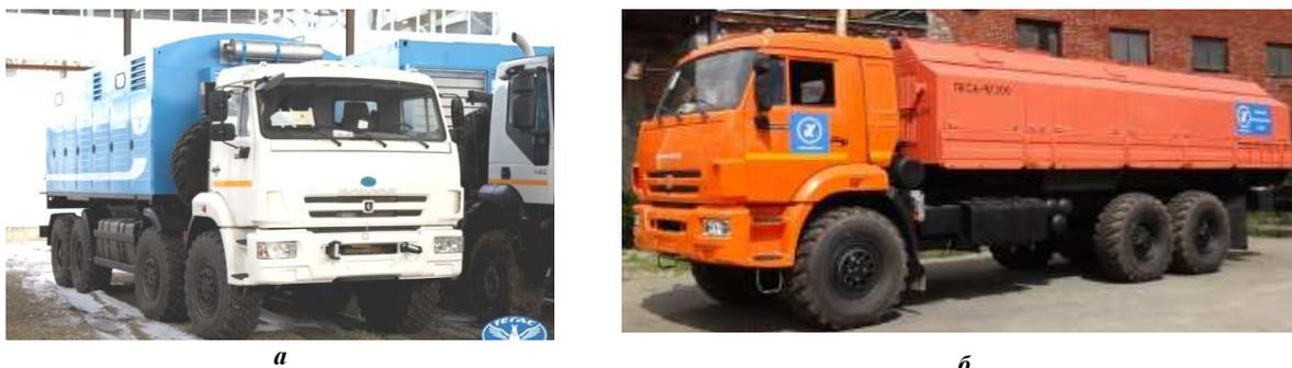
Рисунок 5. – Мобильная компрессорная азотная установка МКАУ-25/13 С-95 (а); передвижная азотная компрессорная станция ПКСА-9/200 (б)
