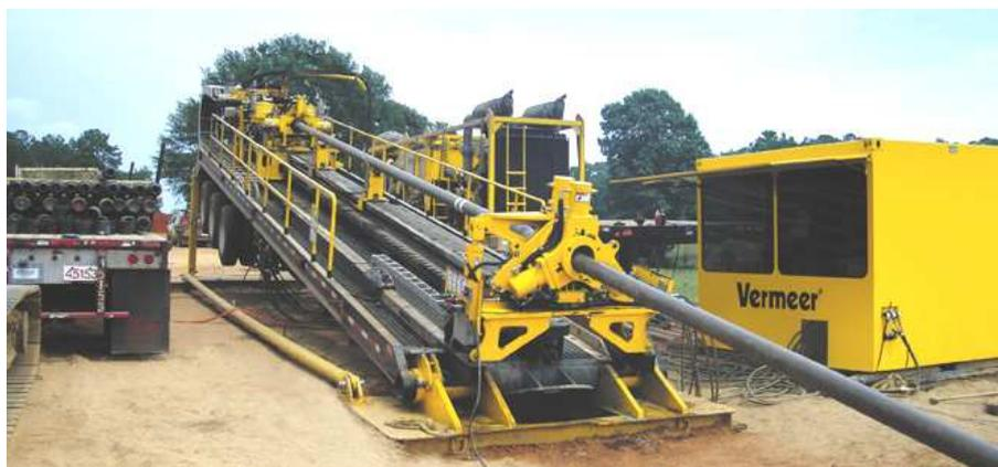
**Рисунок 1. – Установка наклонно направленного бурения**
