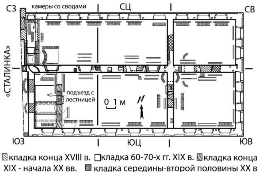
Рисунок 2. – План второго этажа здания с обозначением разновременных кладок
