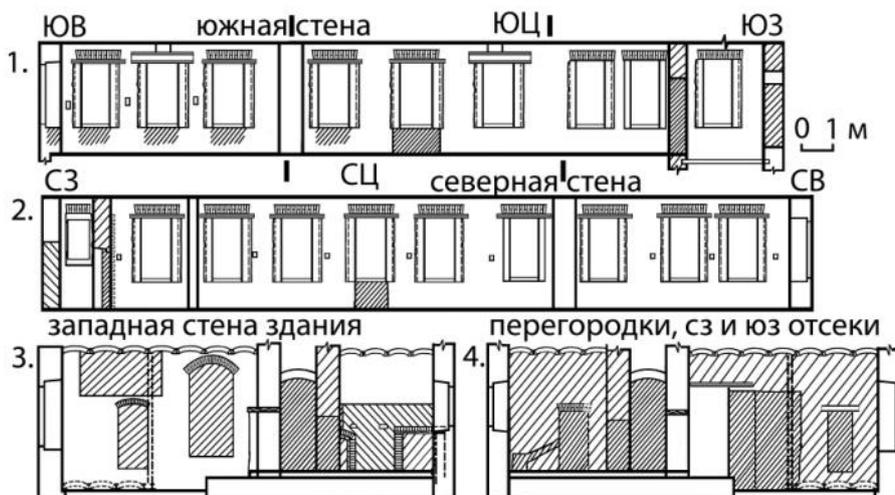
Рисунок 3. – Развертки южной (1), северной (2), западной (3) стены здания, вид перегородки с запада в отсеках СЗ и ЮЗ (4)
