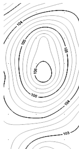
Рисунок 2. – Отфильтрованный рельеф при трехкратном (Filter = 0,8, Std = 0,3 м) вейвлет-сжатии информации
