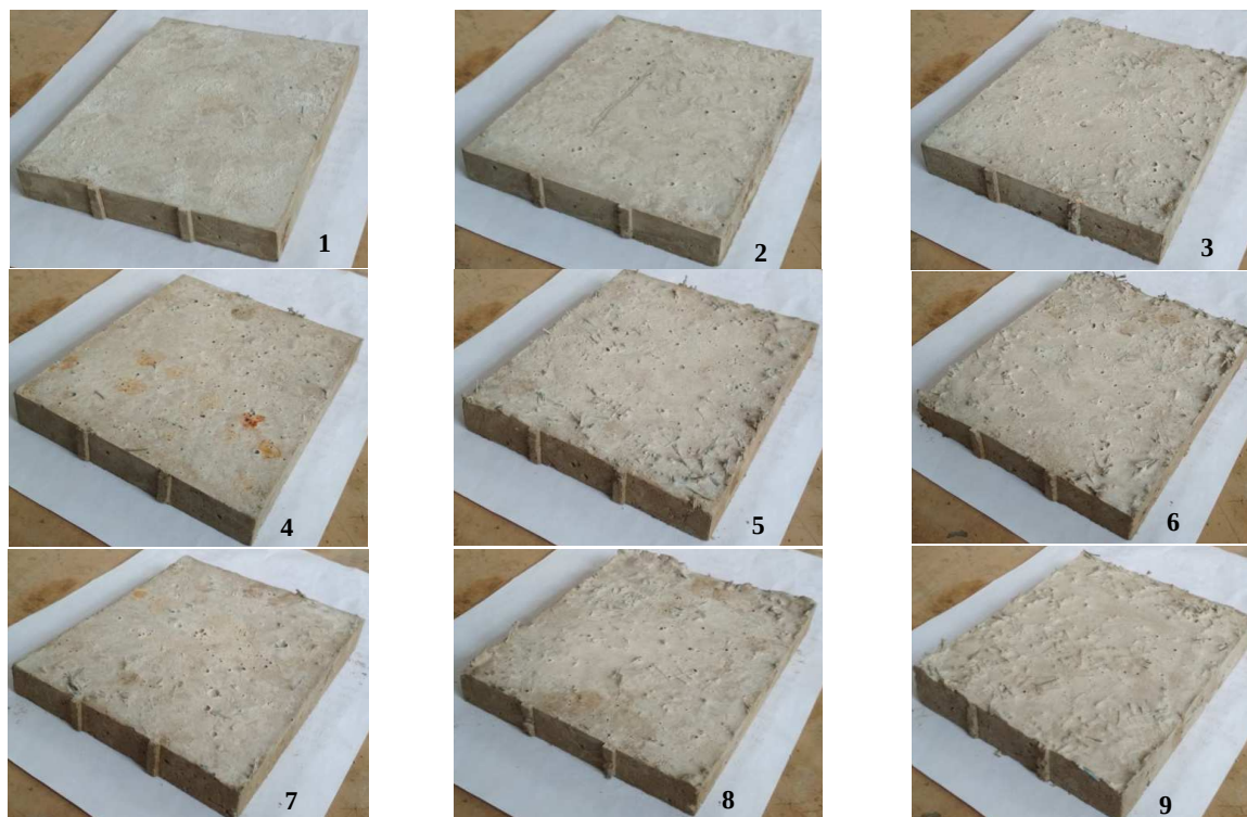
Рисунок 1. – Цементно-песчаные плиты, дисперсно-армированные отходами производства стеклосетки
