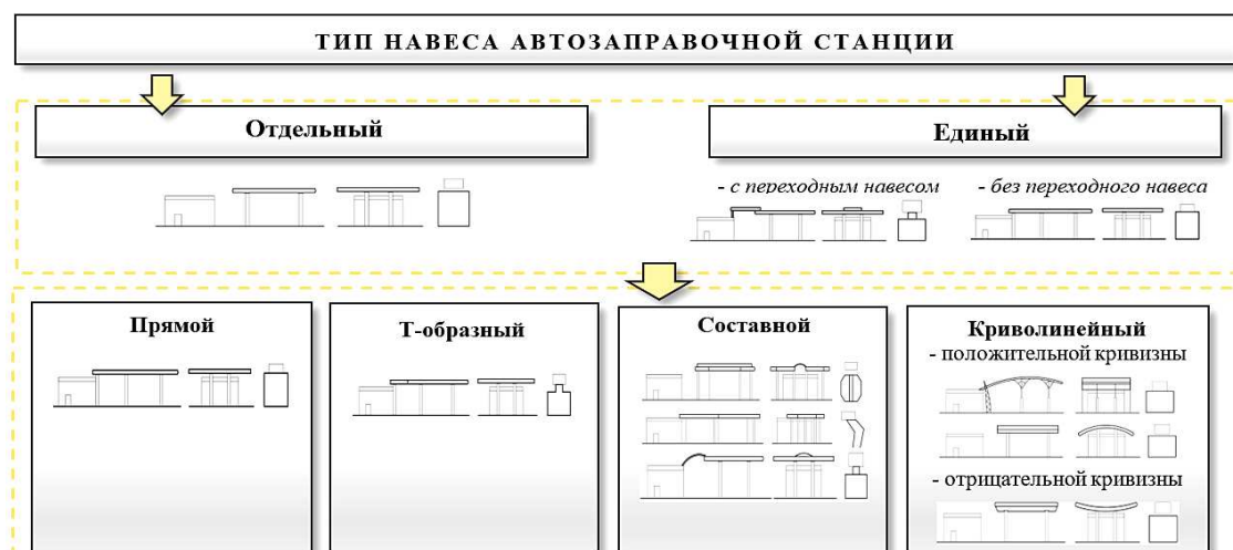
Рисунок 3. – Классификация навесов над ТРК
