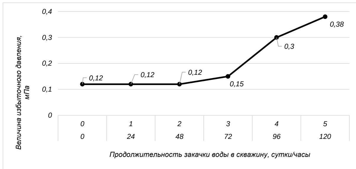
Рисунок 3. – Зависимость роста величины избыточного давления перед эжектором от продолжительности закачки воды в скважину № 2 от скважины № 1
