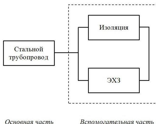
Рисунок 2. – Модель-схема надежности стального подземного газопровода
