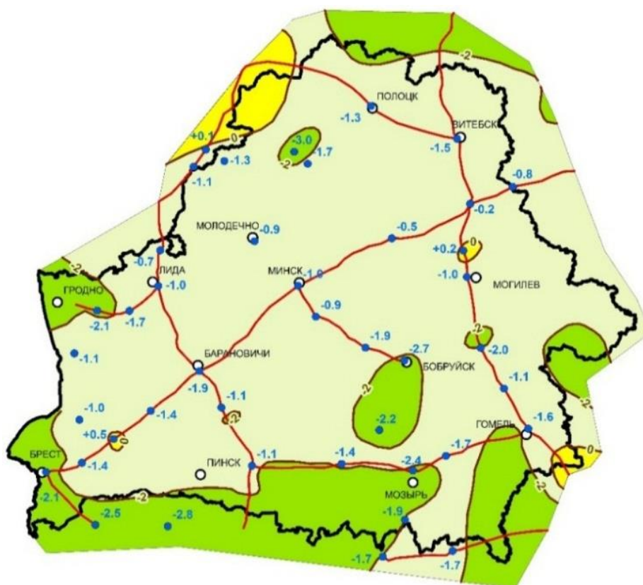
Рисунок 2. – Фрагмент карты современных вертикальных движений земной коры по геодезическим данным на территорию СССР масштаба 1:5000000, 1989 г.
