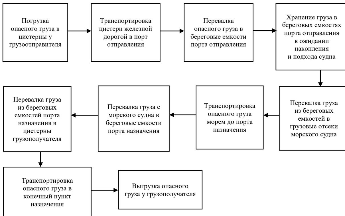
**Рисунок 3. – Схема мультимодальной доставки опасного груза с промежуточным хранением**
