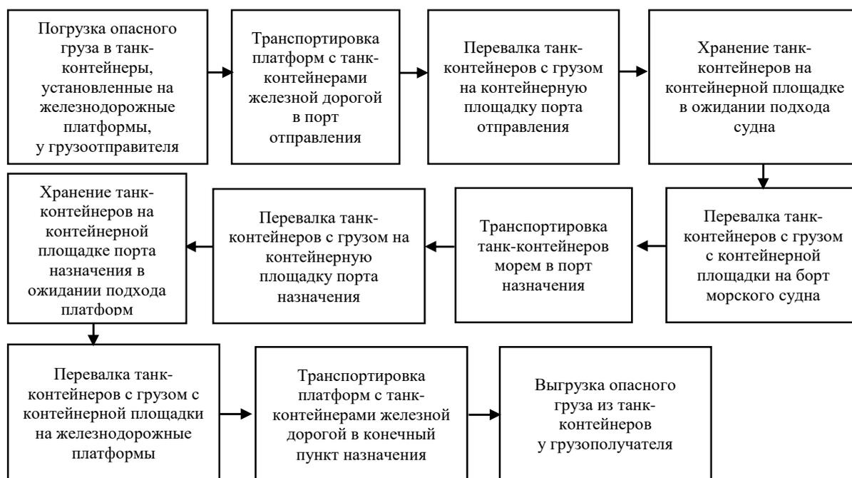
Рисунок 4. – Схема мультимодальной доставки груза с использованием танк-контейнеров
