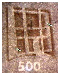
Рисунок 5. – Имитация водяного знака (число «500»), выполненная масляным веществом в денежных билетах Евросоюза (снимок – в проходящих лучах света)
