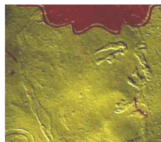
Рисунок 6. – Имитация водяного знака, выполненная тиснением в денежных билетах России (снимок – в косопадающих лучах света)
