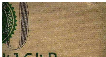
Рисунок 4. – Имитация сетчатой структуры бумаги в денежном билете США достоинством в 100 долларов (выполнено красящим веществом белого цвета с последующим тиснением)
