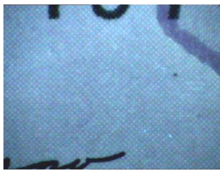
Рисунок 2. – Имитация сетчатой структуры бумаги в денежном билете США достоинством в 100 долларов, выполненная красящим веществом белого цвета (снимок – в ультрафиолетовых лучах света)
