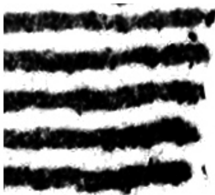
Рис. 6. Увеличенный вид папиллярного узора в следе пальца руки на липкой пленке, оставленном резиновой моделью, изготовленной по флеш-технологии
