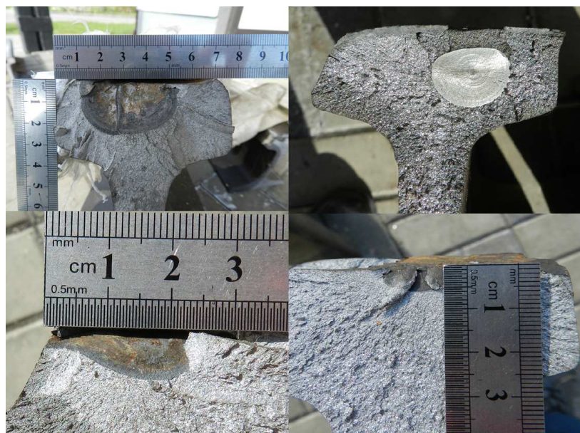
Рисунок 4. – Результаты контрольных доломов рельсов
