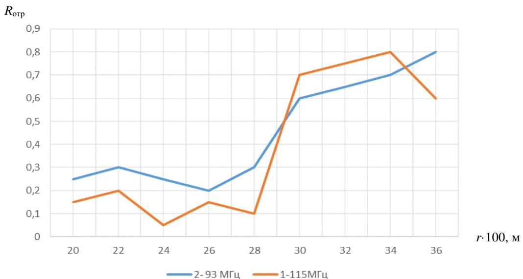
Рисунок 1. – Экспериментальная зависимость коэффициента отражения от расстояния вдоль геопрофиля на частотах 93 и 115 МГц
